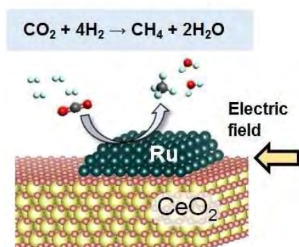
Figura 3. L'idrogenazione della CO 2 in CH 4 procede sul catalizzatore Ru/CeO 2 in un campo elettrico anche a basse temperature inferiori a 473,15 K (200 °C), dove la reazione catalitica convenzionale senza il campo elettrico non procede. Nel campo elettrico, il catalizzatore Ru/CeO 2 mostra un'attività elevata e stabile senza l'ostacolo del CO adsorbito sulla superficie delle particelle Ru.
