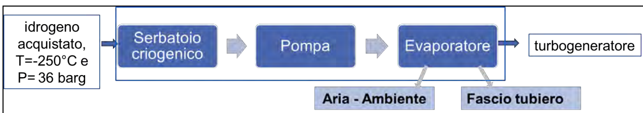
Figura 2. Schema di processo della configurazione B
