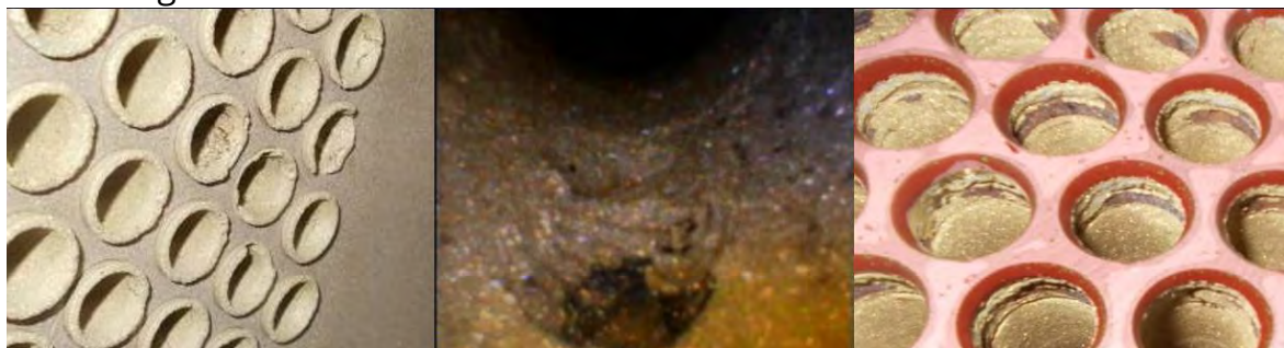
Figura 1. Fenomeni erosivi legati a sovravelocità in combinazione con particolato in sospensione in tubi in Al-brass
